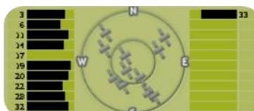
Votre Evadeo essaie d'obtenir une position grâce au signal des satellites. Si vous vous trouvez dans un endroit sans couverture GPS (p.ex. dans un bâtiment) le statut du GPS est "**Sans position**", c'est-à-dire, que votre GPS est connectée à la puce GPS mais que celle-ci ne parvient pas à déterminer votre position à cause de l'absence de signal satellite.
